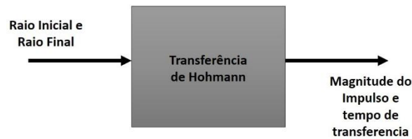
Figura 3.1 – Representação das entradas e saídas na transferência de Hohmann
